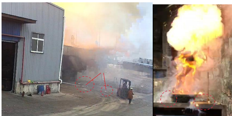
图3 硝化废料固体颗粒燃烧物溅射对比
