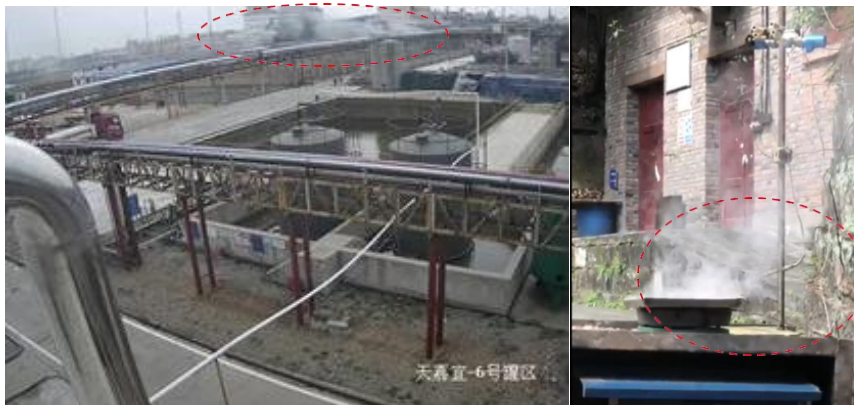
图 1 硝化废料出现明火之前产生烟雾对比
